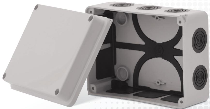
Die Membraneinführungen bestehen aus synthetischem Kautschuk. Diese wurden mittels Co-Injektionsspritzguss mit dem Gehäusekunststoff verbunden, was zu einer hervorragenden Schutzart des Gehäuses führt.
