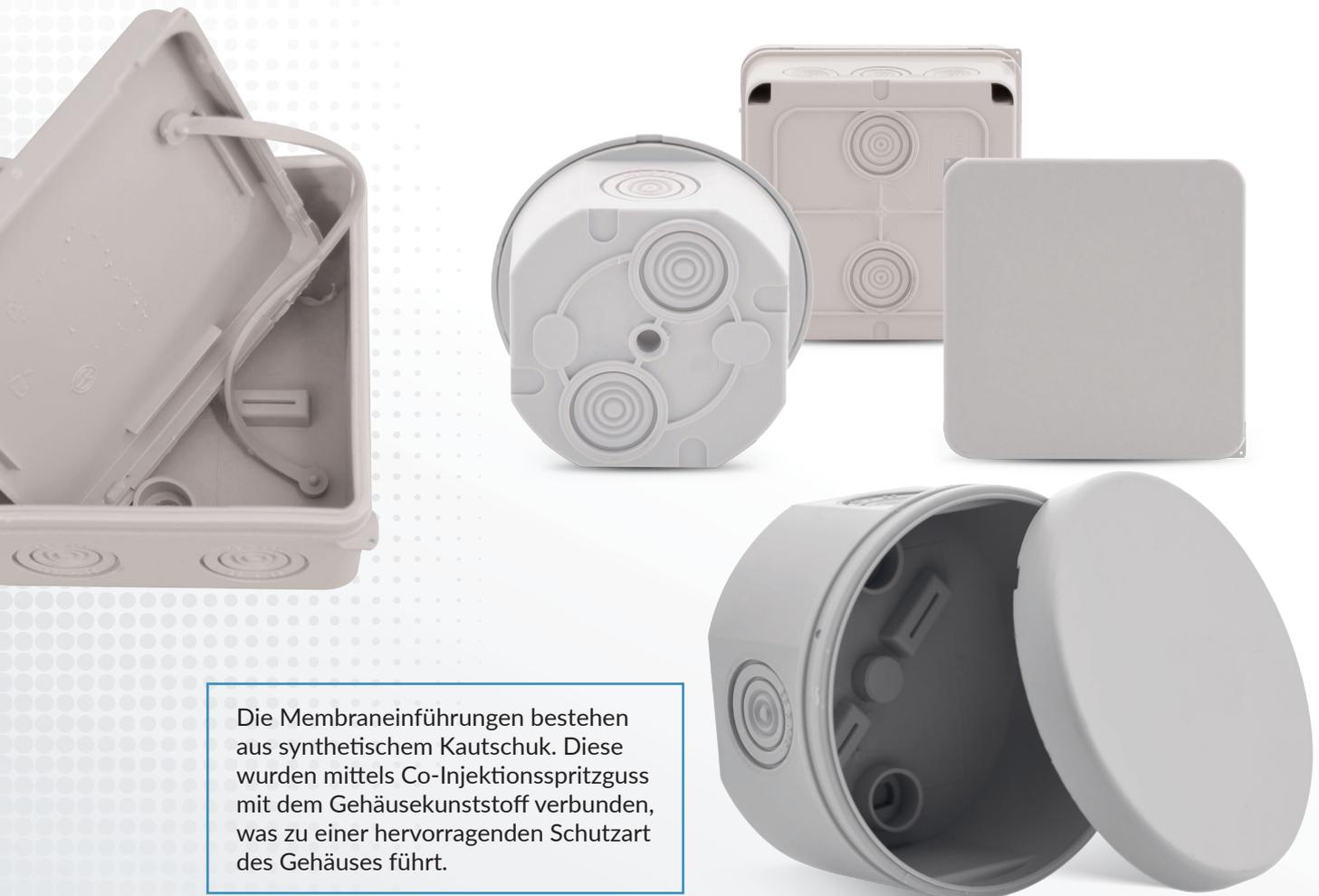
Die Membraneinführungen bestehen aus synthetischem Kautschuk. Diese wurden mittels Co-Injektionsspritzguss mit dem Gehäusekunststoff verbunden, was zu einer hervorragenden Schutzart des Gehäuses führt.
